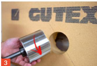
3 Das Auswurfsystem durch eine Drehbewegung öffnen.
